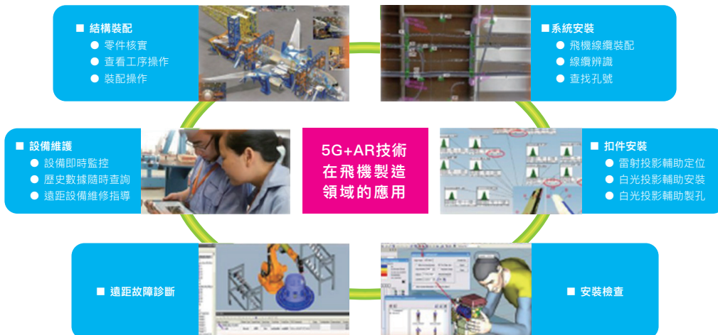
圖 1-2-29 中國商飛 5G 結合 AR 技術在飛機製造領域的應用
