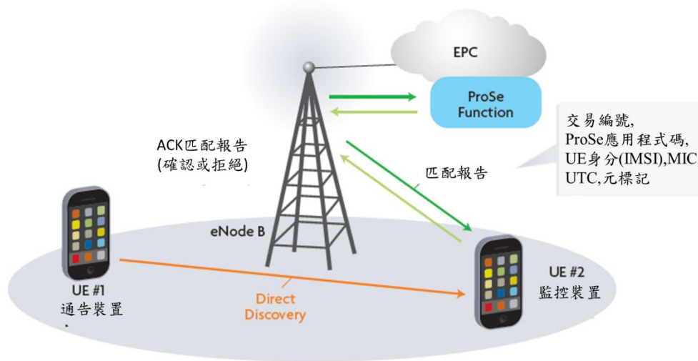
圖 13、LTE-Direct 原理示意圖
