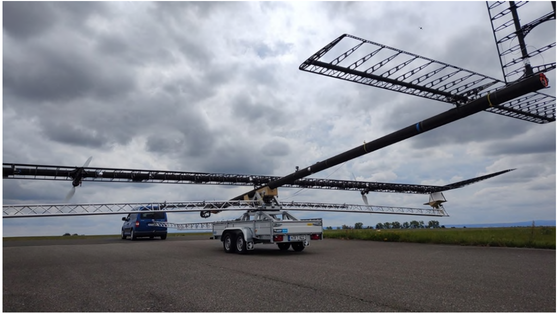
圖 7：HAP-alpha於德國無人機系統測試中心，完成地面滑行測試 資料來源：Global people daily news
