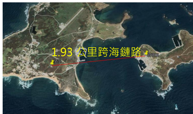
圖 5-26、望安將軍嶼既有微波鏈路與 FSO 鏈路距離
