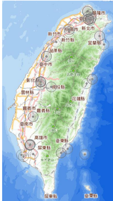
圖 5- 89、U6 頻段無線電視發射站半徑 10 公里涵蓋範圍圖 資料來源：NCC，本研究整理
