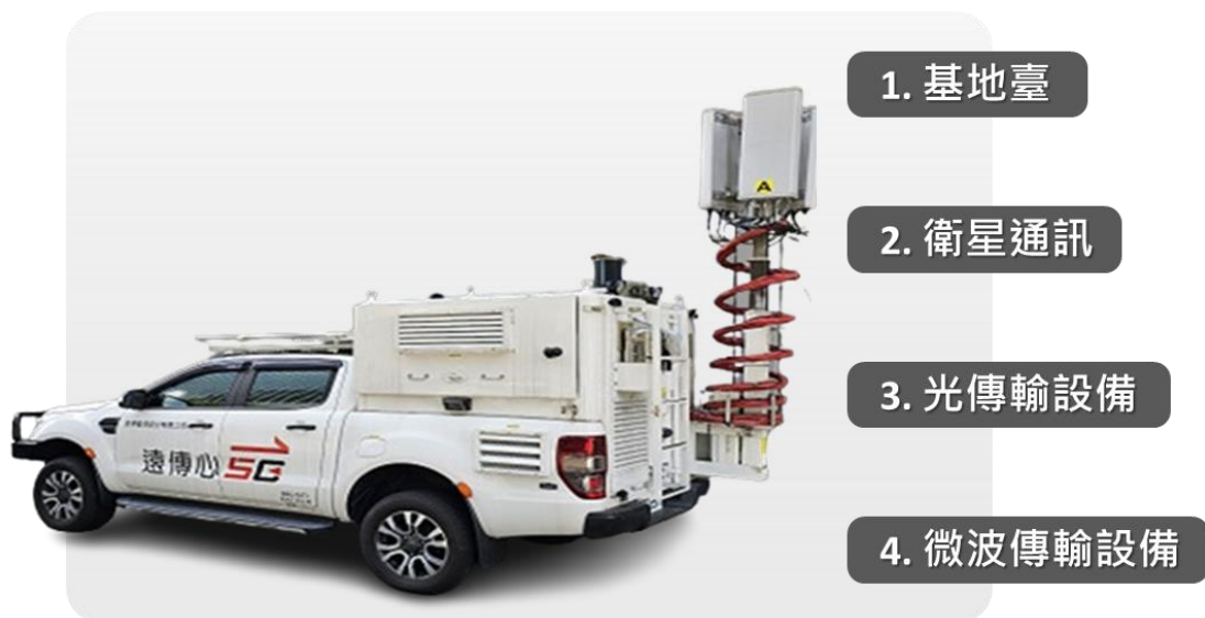
圖 27、移動式通訊平臺搭載設備
