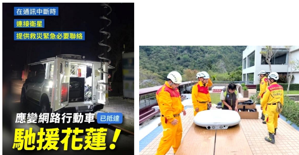
圖 9、運用非同步軌衛星於花蓮震災建立救災緊急通訊網路
