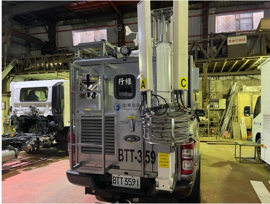
圖 13、搭載非同步衛星的移動式通訊平臺
