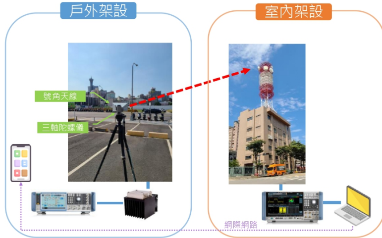
圖 4-8、干擾架設與量測方式
