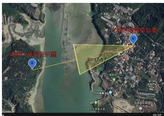
圖 4-53、中華電信大埔<>埔頂中興微波鏈路視域分析
