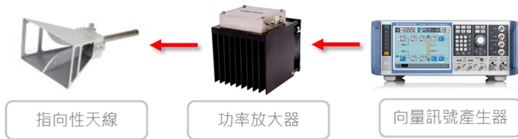
圖 4- 48、移動型發射電臺發射端架構
