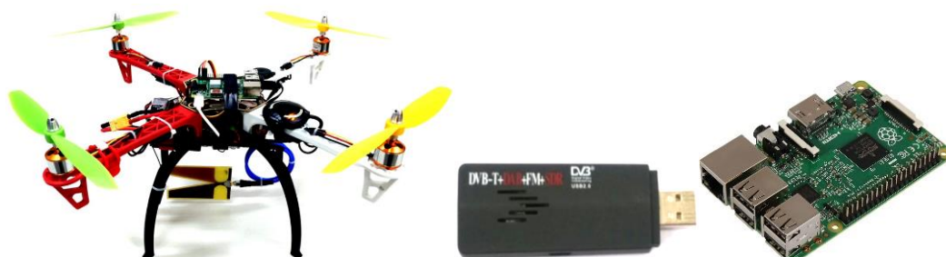
圖 5- 18、無人機搭載 SDR 執行訊號量測任務原型
