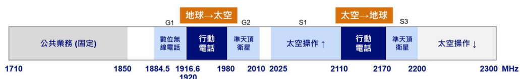
圖 3-4 日本就衛星直連手機於 2 GHz 頻段共用干擾評估之目標頻段
