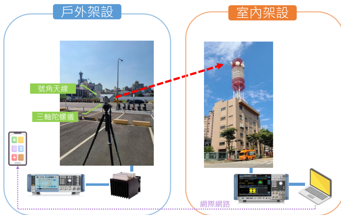
圖 3- 46、干擾架設與量測方式
