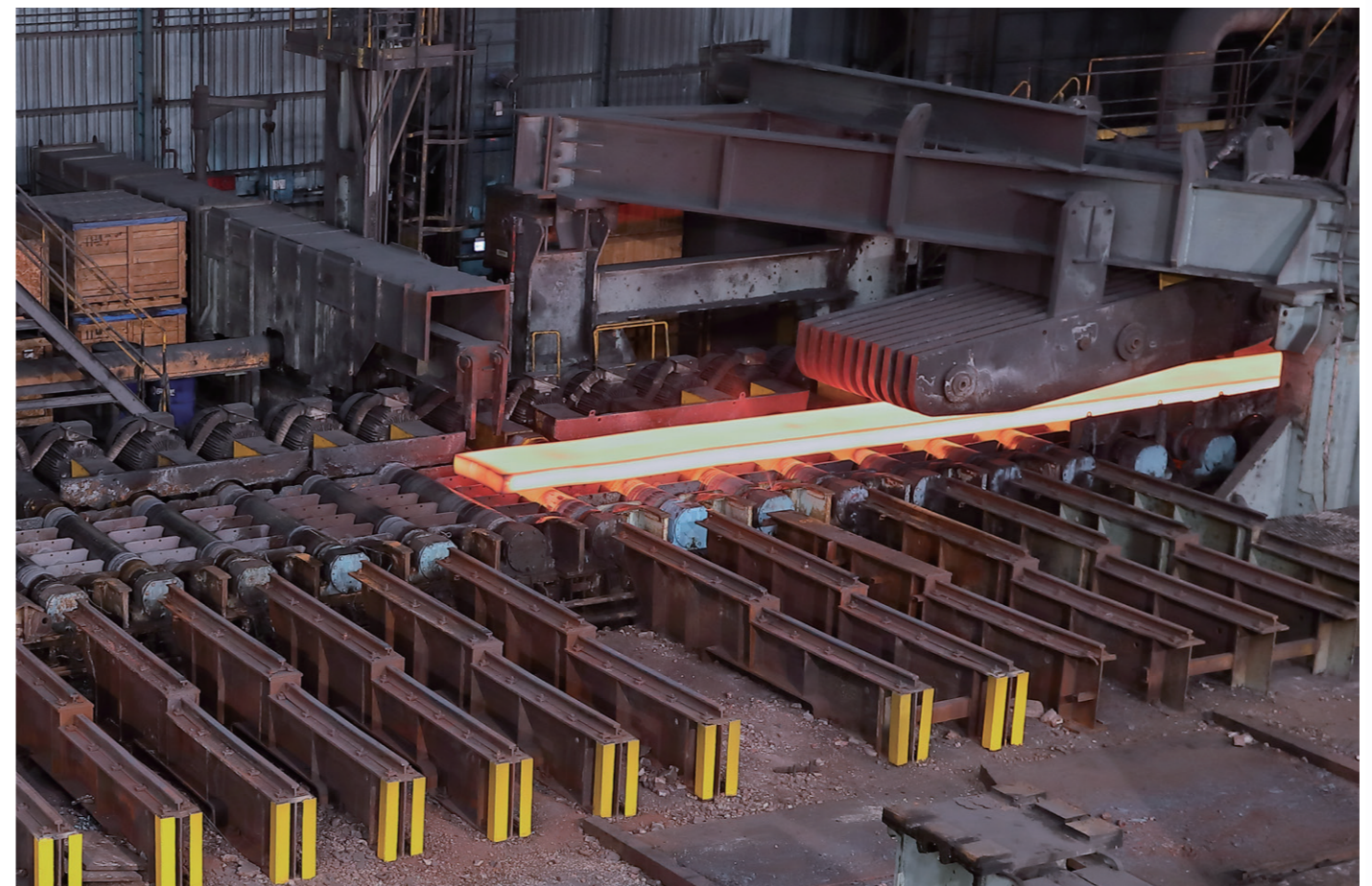
中龍鋼鐵熱軋工場藉由 AI 預測軋延寬度，精準控制熱軋厚寬度，解決工場長期痛點。
